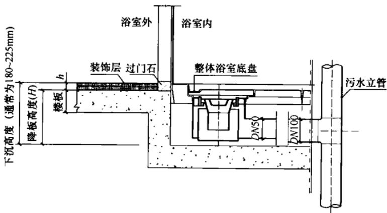
图 4 整体浴室同层排水构造示意
